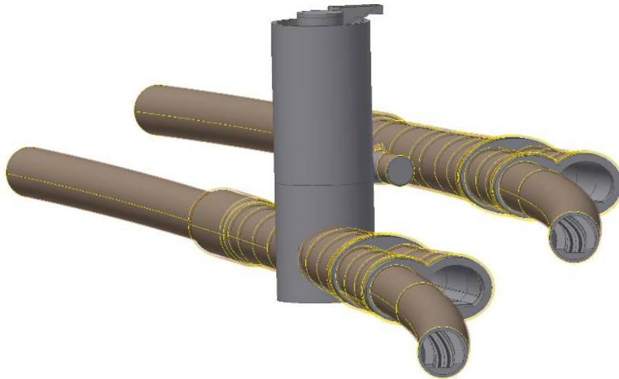
Abb. 2.2-2: BIM-Modell eines Abzweigbauwerks der 2. S-Bahnstammstrecke in München.
