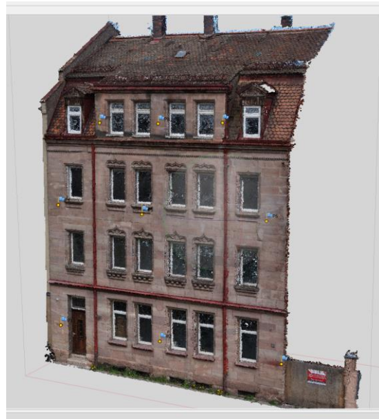
Abb. 3.1.6-3: Punktwolke mit Referenzmarken während der photogrammetrischen Bearbeitung.
