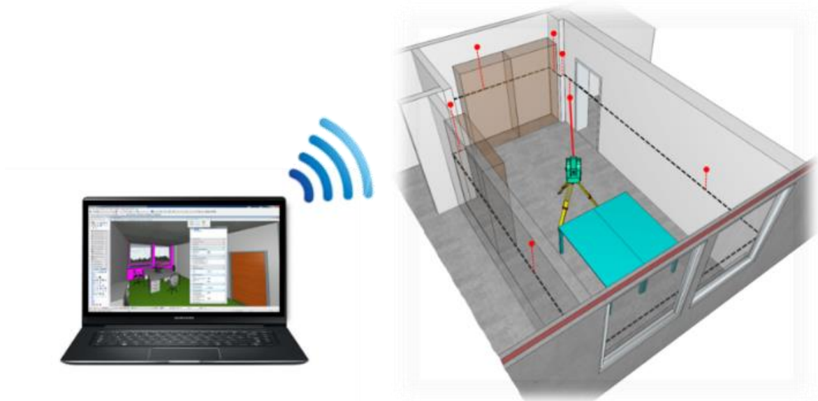
Abb. 2.5-2: Prinzip der Einzelpunkt-basierten Erfassung und Modellierung für BIM.
