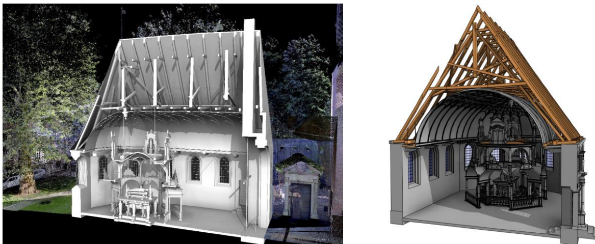
Abb. 3.1.10-4: Bauteilstrukturiertes Bestandsmodell (BIM) des Edo-Wiemken-Denkmal.
