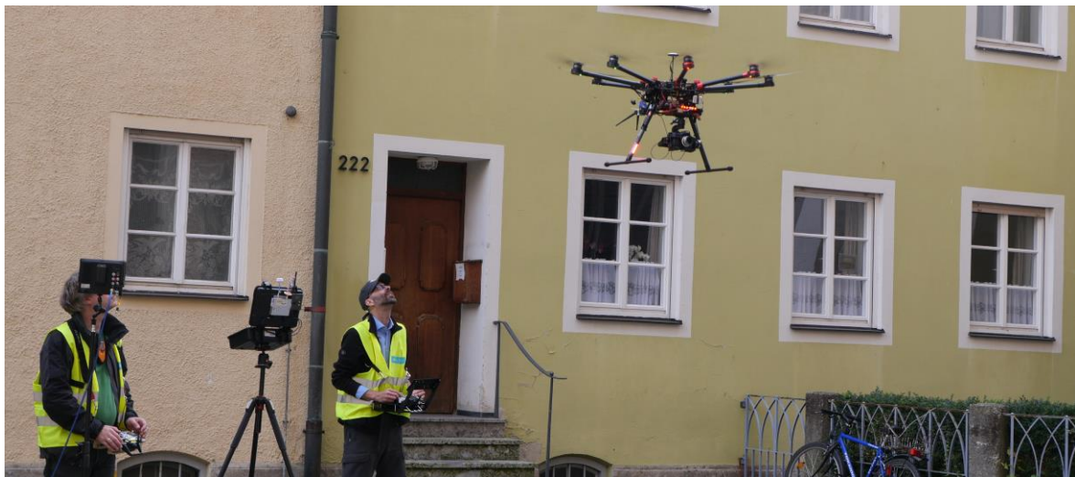
Abb. 3.1.6-1: Bestandserfassung durch Drohnenflug.
