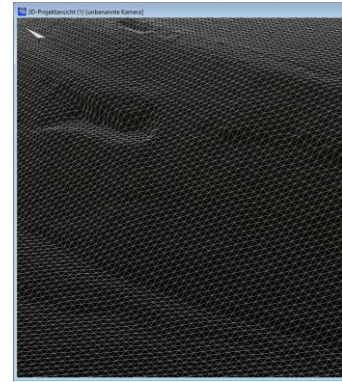
Abb. 3.2.8-3: DGM aus XYZ-Datei mit 1-m-Gitterabstand in der 3D-Ansicht.
